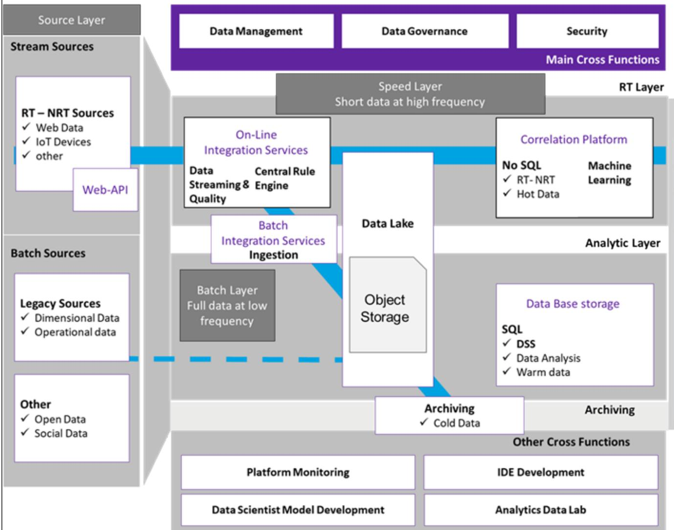
L'architettura schematizzata è un modello di implementazione che permette di governare enormi quantità di dati sfruttando di volta in volta i metodi più opportuni di elaborazione dati, in modo da gestire i diversi formati bilanciando la latenza, il throughput e la tolleranza agli errori.
